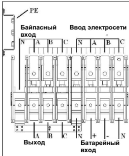
Рис. 2-18 Клеммная колодка ИБП 250/300кВА
