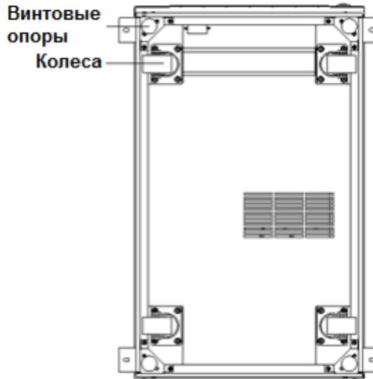
Рис. 2-10 Винтовые опоры и колеса (вид снизу)
